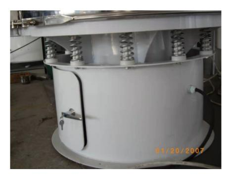
超声波筛分系统是一种简单实用、可靠的筛分系统,是当前网孔堵塞的有效的解决方法。可广泛应用于制药、冶金、化工、选矿、食品等要求精细筛分过滤的行业,筛分过滤精度高,有效解决因团聚、静电、强吸附性卡堵网孔等筛分难题,是国内筛分行业的一项重大技术突破。上海超声波发生器超声波系统外置超声波发生器厂家:外置超声波系统参数:电源输入:交流220V10%50~60Hz整机电流□≤0.5A高频电流□≤0.4A工作频率□37KHz□双频。工作模式:双频振动环境温度:-10~60℃设备功率□80-120W
